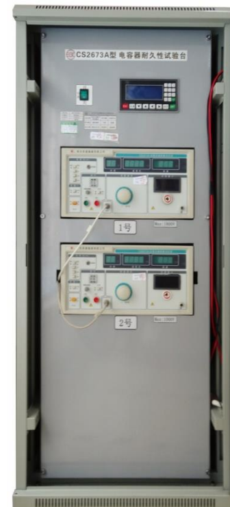
直流电容器耐久性试验台
