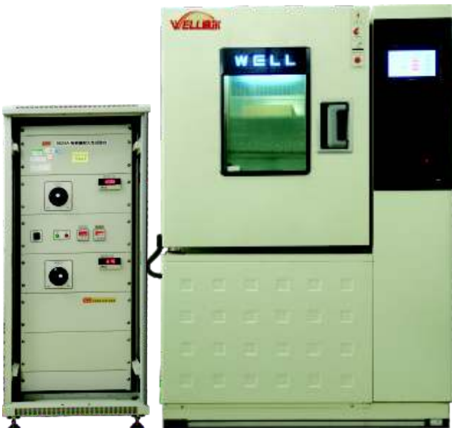
↑ 交流电容器耐久性试验台
