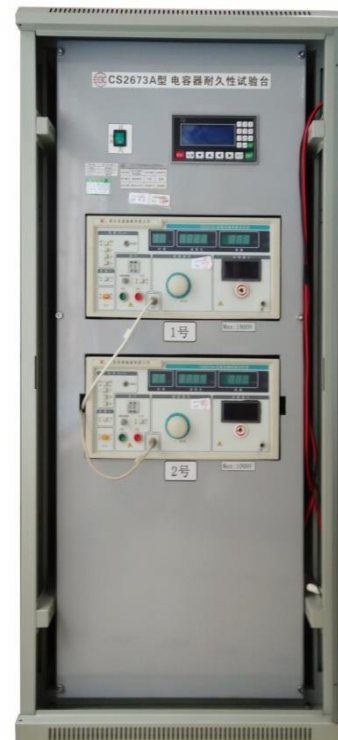
直流电容器耐久性试验台
